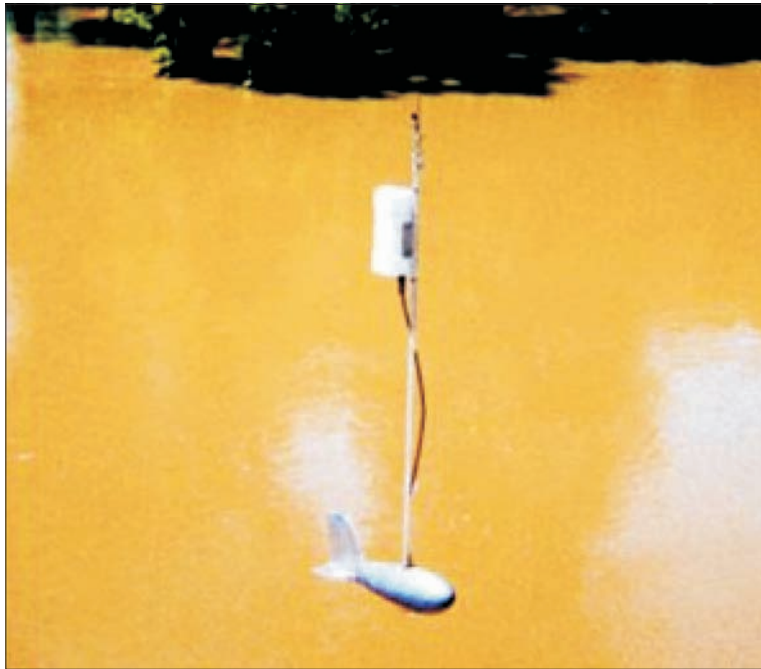
Rys. 37. Sonar zawieszony na linie stalowej z obciążnikiem w kształcie torpedy [Internet]
