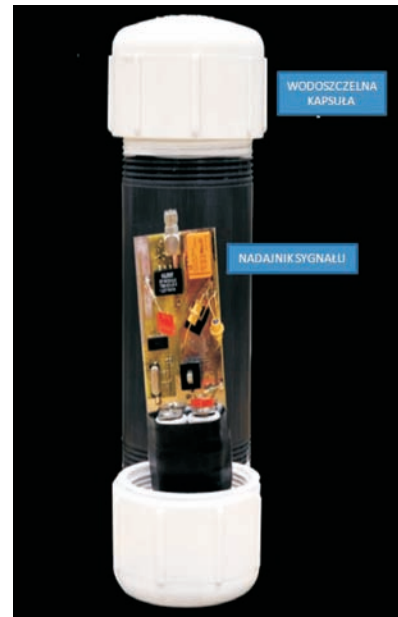
Rys. 12. Elementy wypływającego czujnika rozmyć [University of Pittsburg, Swanson School of Engineering, Internet]
