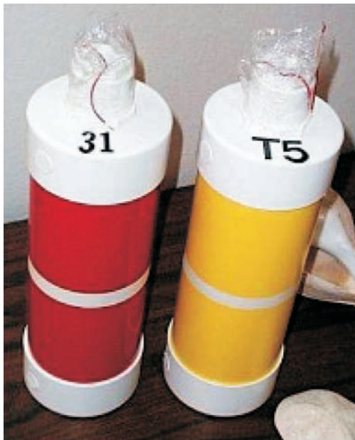
Rys. 11. Wypluwające czujniki rozmycia przed osadzeniem w podłożu cieku. Kolor i numer czujnika umożliwiają jego identyfikację [13]
