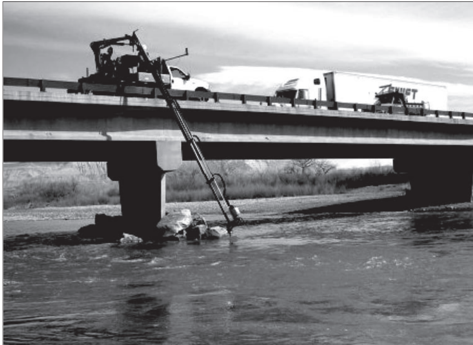
Rys. 41. Doprowadzanie sonaru do miejsc pomiaru systemem przegubowego wysięgnika zainstalowanego na ciężarówce [13]
