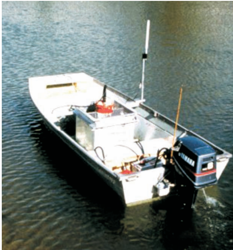
Rys. 43. Bezzałogowa łódź stosowana jako nośnik przenośnych przyrządów monitoringu rozmyć [13]
