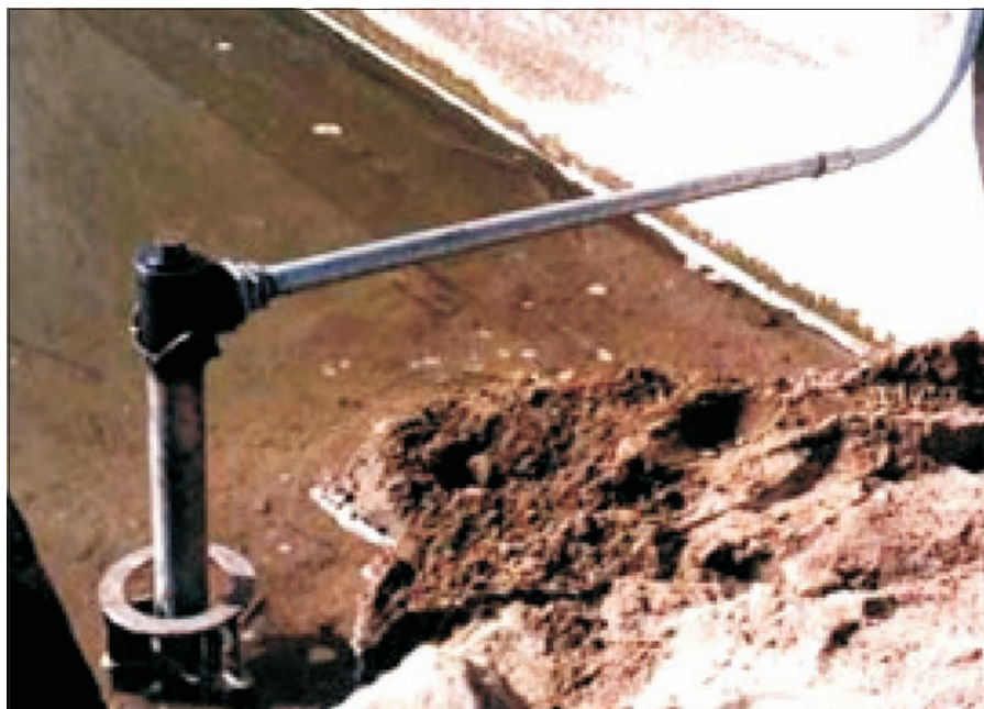
Rys. 21. Widok magnetycznego pierścienia opadającego, leżącego na dnie cieku, systemu zautomatyzowanego [13]
