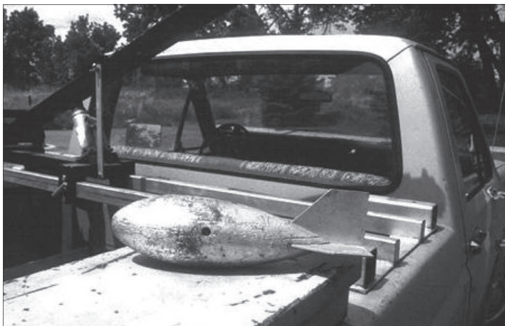
Rys. 2. Obciążnik sondy fizycznej z linki stalowej mający kształt torpedy; obciążniki są o masie od 7 do 45 kg; sondy z obciążnikiem cięższym niż 10 kg są obsługiwane wciągarką [13]
