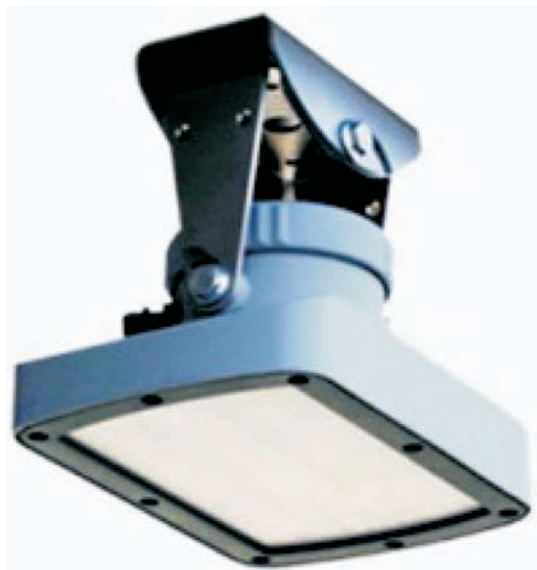
Rys. 25. Radarowy czujnik poziomy do bezkontaktowego pomiaru odległości od zwierciadła wody; umożliwia pomiar z wysokości do 35 m w szerokim zakresie temperatur i zmian poziomu zwierciadła wody [Internet]
