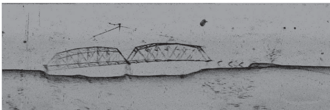
Rys. 11. Echogram zawalonego mostu uzyskany sonarem bocznym [6]
