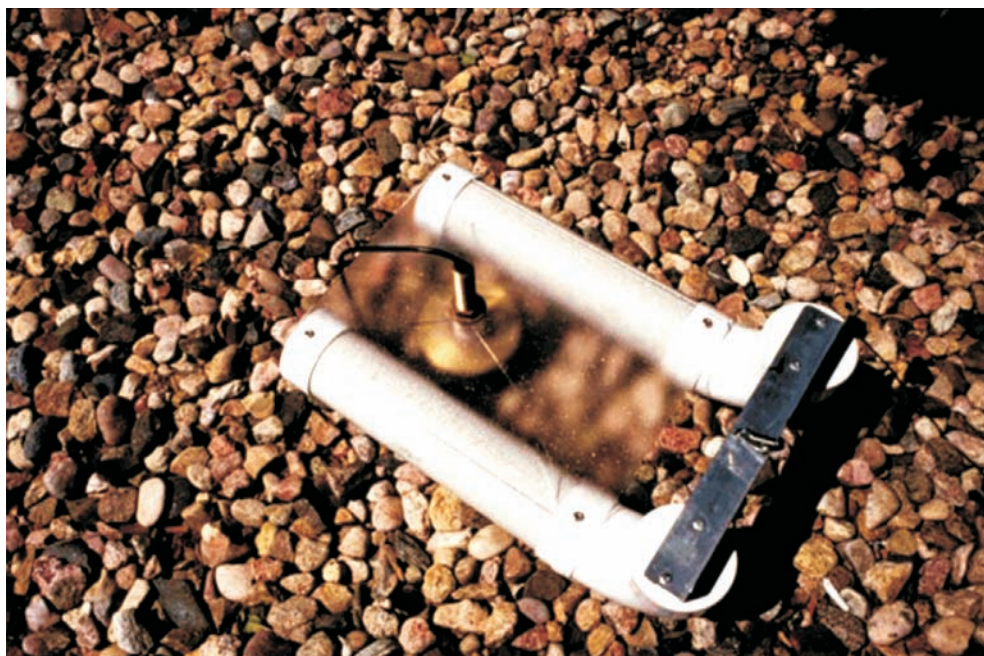
Rys. 44. Pływak stosowany jako nośnik na uwięzi sonaru [13]
