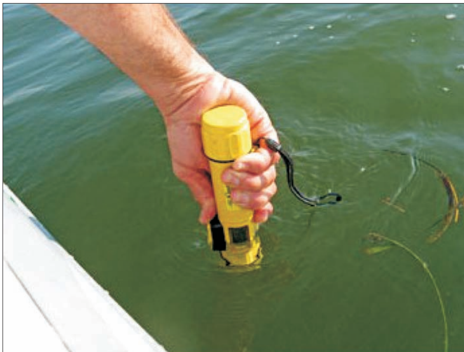
Rys. 28. Manualna, cyfrowa echosonda do pomiaru głębokości; działa z częstotliwością 200 kHz, jest zasilana baterią 9V, która umożliwia wykonanie 500 pomiarów; wysyła sygnał akustyczny, odbity przekształca w elektryczny; wyłącza się automatycznie po 10 s; koszt tego rodzaju przyrządu jest od kilkudziesięciu do dwustu kilkudziesięciu euro [Internet].
