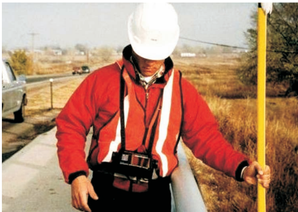
Rys. 36. Pomiar z mostu głębokości dna cieku sondą fizyczną z tyczki zakończonej echosondą [13]
