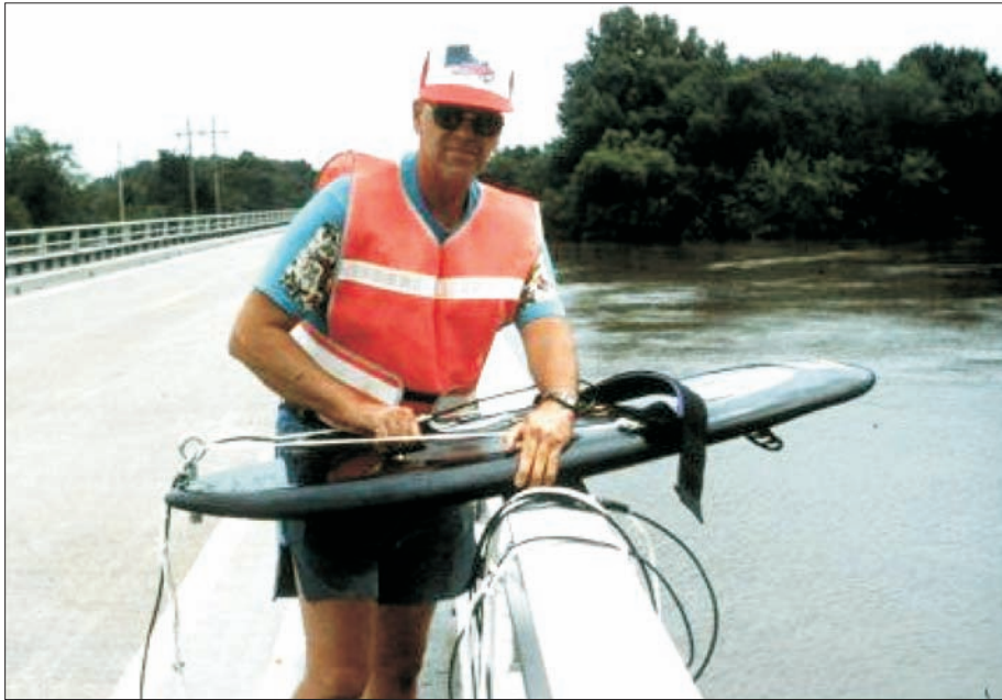
Rys. 45. Deska do pływania na kolanach stosowana jako nośnik na uwięzi sonaru [13]
