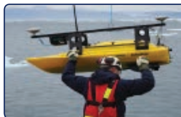
Wodowanie łodzi EchoBoat za pomocą dźwigu
