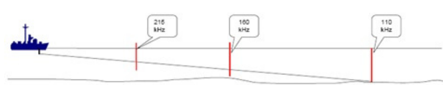
Rys. 5 Osiągany zasięg w zależności od częstotliwości
